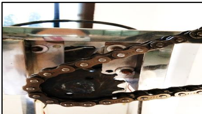
ภาพที่ 3-32 แสดงการติดตั้งระบบโซ่ช่วยส่งกำลังชุดแกนยกเส้นไหมเข้ากับโครงสร้างของเครื่อง (ที่มา : วทัญญู บุตรศรี, 2560)
