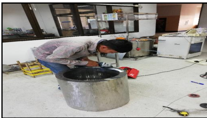
ภาพที่ 3-53 แสดงการขัดหม้อย้อมสี เพื่อที่จะเตรียมประกอบเข้ากับชุดโครงสร้างเครื่อง (ที่มา : วทัญญู บุตรศรี, 2561)
