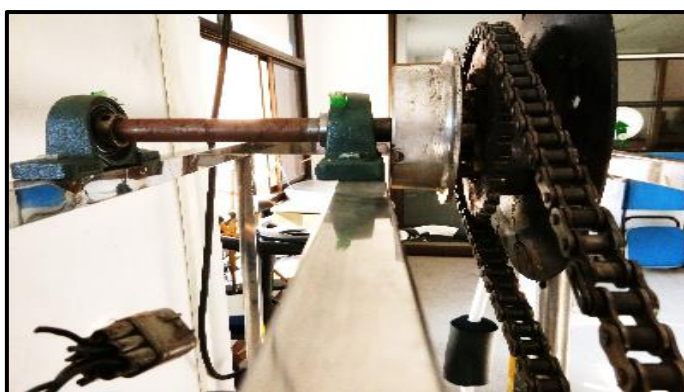
ภาพที่ 3-33 แสดงการติดตั้งและทดสอบระบบช่วยส่งกำลังชุดแกนยกเส้นไหม (ที่มา : วทัญญู บุตรศรี, 2560)
