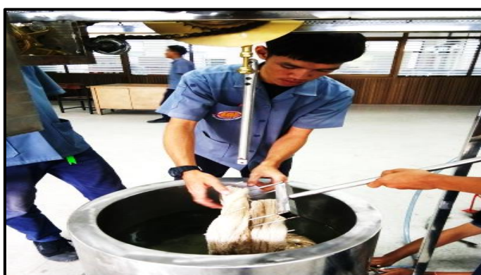
ภาพที่ 3-73 แสดงการทดสอบใส่เส้นฝ้ายประกอบเข้ากับชุดแกนยกเส้นไหม (ที่มา : วทัญญู บุตรศรี, 2561)
