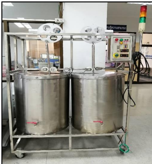
ภาพที่ 3-118 แสดงเครื่องย้อมสีเส้นไหมและฝ้ายแบบใช้หม้อต้มประหยัดพลังงาน รุ่นที่ 5 (ที่มา : วัทัญญ บุตรศรี, 2562)
