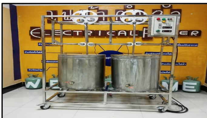
ภาพที่ 3-150 แสดงด้านหน้าของเครื่องย้อมสีเส้นไหมและฝ้ายในรุ่นที่ 5 (ที่มา : วทัญญู บุตรศรี, 2562)
