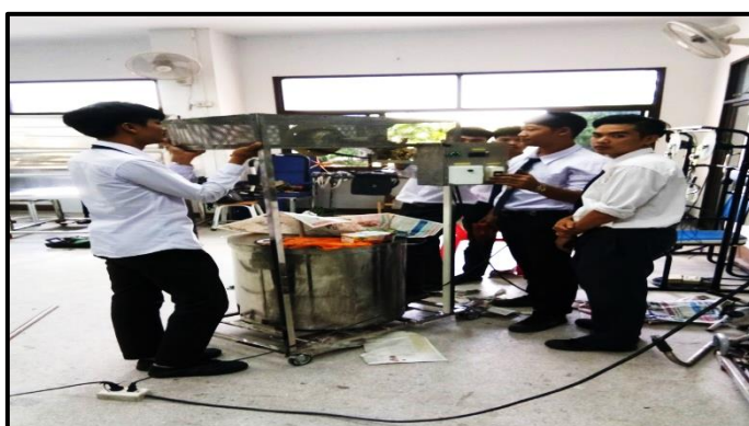
ภาพที่ 3-55 แสดงการติดตั้งตะแกรงครอบชุดระบบส่งกำลังเข้ากับโครงสร้างเครื่อง (ที่มา : วทัญญู บุตรศรี, 2561)
