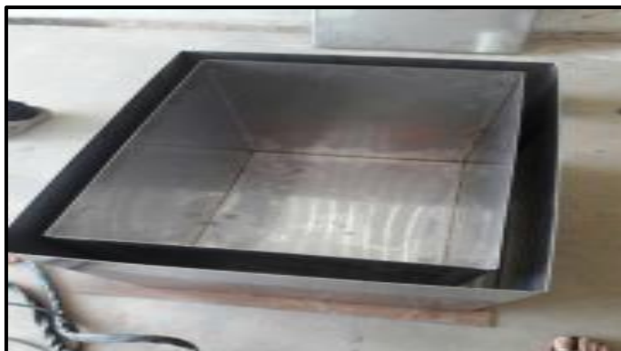
ภาพที่ 3-8 แสดงการประกอบถังรูปทรงสี่เหลี่ยม สำหรับทำเป็นหม้อต้มย้อมสี (ที่มา : วัทัญญ บุตรศรี, 2560)
