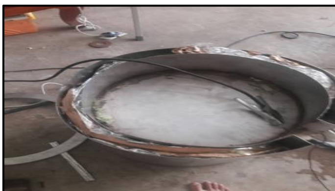
ภาพที่ 3-86 แสดงการใส่ฉนวนกันความร้อนรอบหม้อย้อมสี (ที่มา : วทีญญ บุตรศรี, 2561)
