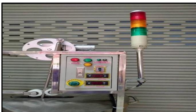
ภาพที่ 3-148 แสดงการประกอบและติดตั้งไฟสัญญาณเตือนแบบชั้น (ที่มา : วทีญญ บุตรศรี, 2562)
