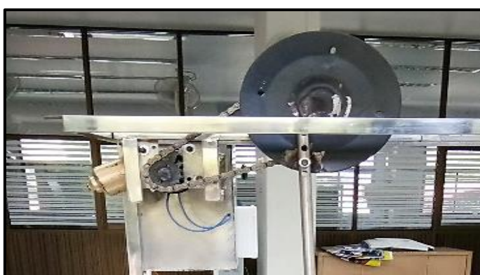
ภาพที่ 3-34 แสดงการประกอบติดตั้งมอเตอร์ไฟฟ้ากระแสตรงขนาด 12 โวลต์ (ที่มา : วทัญญู บุตรศรี, 2560)
