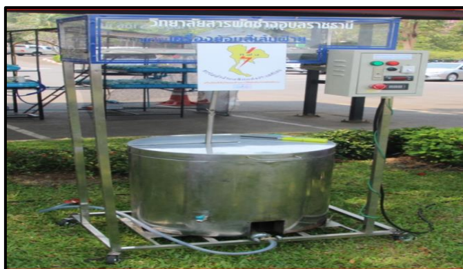
ภาพที่ 3-116 แสดงเครื่องย้อมสีเส้นไหมและฝ้ายแบบใช้หม้อต้มประหยัดพลังงาน รุ่นที่ 4 ที่ได้ส่งมอบให้กับชุมชนบ้านโนนสำราญ (ที่มา : วทัญญู บุตรศรี, 2561)
