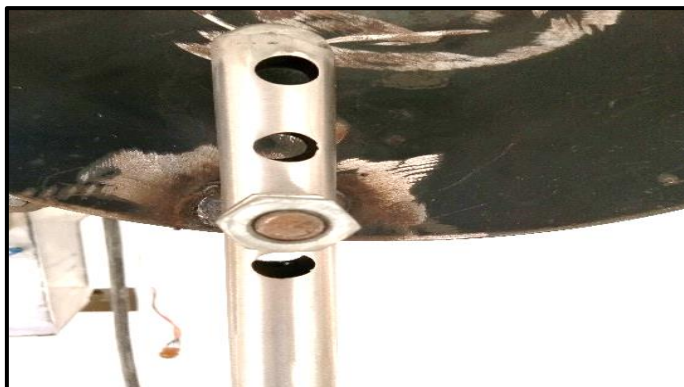
ภาพที่ 3-38 แสดงการประกอบและติดตั้งการเจาะปรับระดับของชุดแกนยกเส้นไหมเข้ากับแกนเพลลา (ที่มา : วทัญญู บุตรศรี, 2560)
