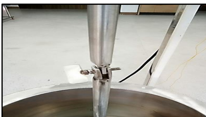
ภาพที่ 3-37 แสดงการประกอบและติดตั้งข้อต่อช่วยส่งกำลังของชุดแกนยกเส้นไหม (ที่มา : วทัญญู บุตรศรี, 2560)
