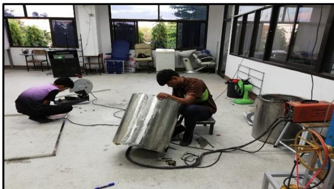
ภาพที่ 3-51 แสดงการเชื่อมและประกอบหม้อย้อมสี (ที่มา : วทีญญ บุตรศรี, 2561)
