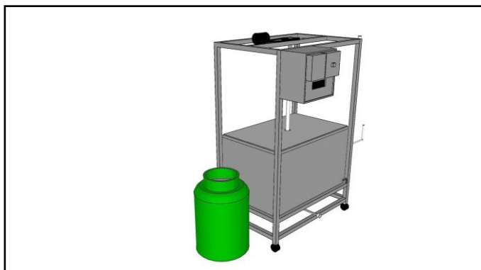
ภาพที่ 3-2 แสดงแบบร่างด้านหน้าเครื่องย้อมสีเส้นไหมและฝ้ายแบบใช้หม้อต้มประหยัดพลังงานรุ่นที่ 1 (ที่มา : วทีญญ บุตรศรี, 2560)
