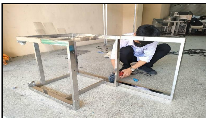
ภาพที่ 3-6 แสดงการประกอบโครงสร้างเครื่อง (ที่มา : วทัญญู บุตรศรี, 2560)
