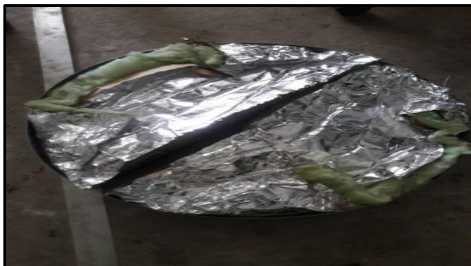
ภาพที่ 3-85 แสดงการใส่ฉนวนกันความร้อนรอบหม้อย้อมสี (ที่มา : วทีญญ บุตรศรี, 2561)
