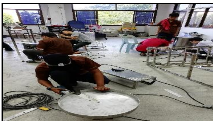
ภาพที่ 3-123 แสดงการเชื่อมประกอบและขึ้นรูปฝาปิดเครื่อง (ที่มา : วทัญญู บุตรศรี, 2562)
