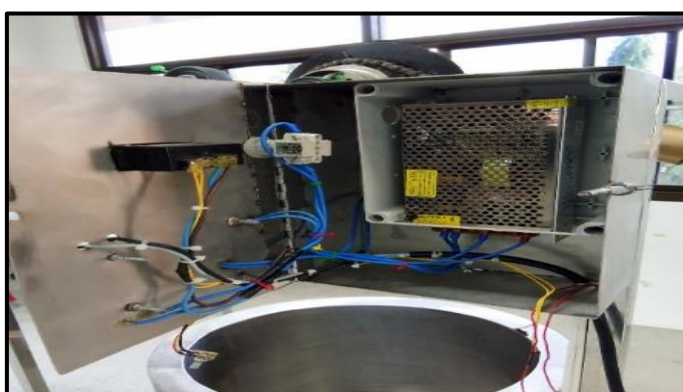
ภาพที่ 3-99 แสดงอุปกรณ์ภายในตู้ควบคุมระบบไฟฟ้าของเครื่อง (ที่มา : วทิญญ บุตรศรี, 2561)
