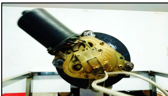
ภาพที่ 3-12 แสดงการติดตั้งมอเตอร์ไฟฟ้าขนาด 12 โวลต์ เพื่อเป็นกำลังที่ช่วยยกตะแกรงเส้นไหม (ที่มา : วทัญญู บุตรศรี, 2560)
