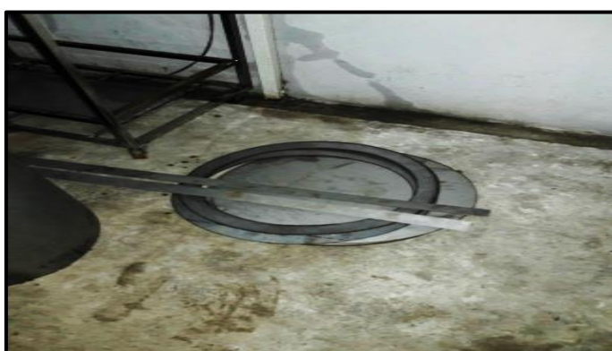
ภาพที่ 3-83 แสดงการตัดแผ่นสแตนเลสเพื่อจัดทำฝาปิดหม้อย้อมสี (ที่มา : วทัญญู บุตรศรี, 2561)
