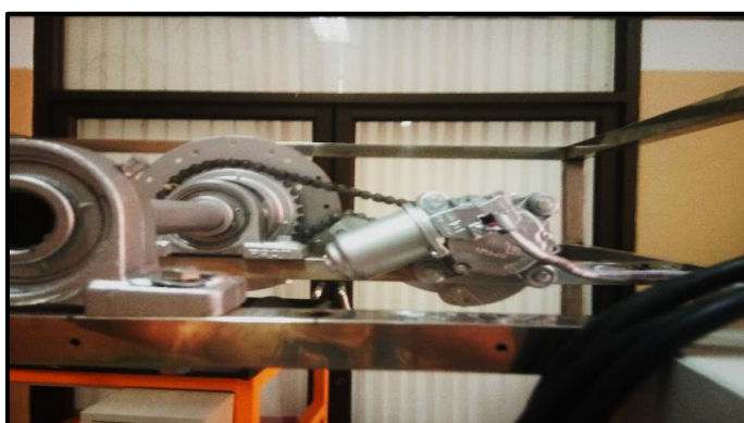
ภาพที่ 3-64 แสดงการติดตั้งมอเตอร์ไฟฟ้าและเฟลาส่งกำลังเพื่อใช้ในการช่วยยกเส้นไหมแทนมือชาวบ้าน (ที่มา : วทัญญู บุตรศรี, 2561)
