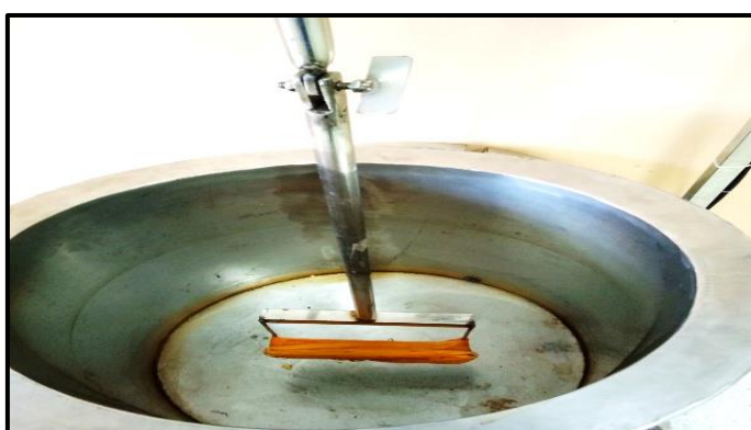
ภาพที่ 3-40 แสดงการทดสอบระบบส่งกำลังชุดแกนยกเส้นไหม (ที่มา : วทัญญู บุตรศรี, 2560)
