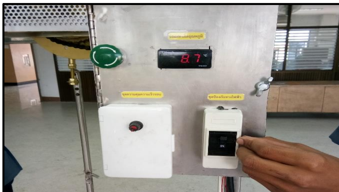
ภาพที่ 3-17 แสดงการทดสอบชุดควบคุมระบบไฟฟ้า (ที่มา : วัทัญญ บุตรศรี, 2560)
