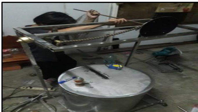
ภาพที่ 3-88 แสดงการเชื่อมประกอบระบบโครงสร้างเครื่อง (ที่มา : วทีญญ บุตรศรี, 2561)
