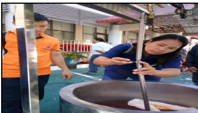
ภาพที่ 3-110 แสดงตัวแทนชุมชนบ้านคำขวางกำลังทดสอบประกอบชุดแกนยกเส้นไหม (ที่มา : วทีญญ บุตรศรี, 2561)
