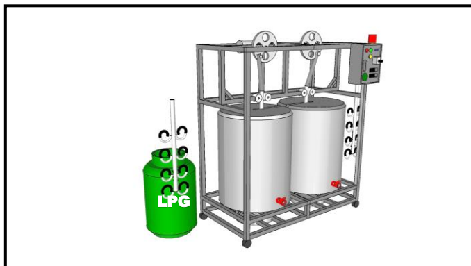
ภาพที่ 3-119 แสดงแบบร่างด้านข้างเครื่องย้อมสีเส้นไหมและฝ้าย แบบใช้หม้อต้มประหยัดพลังงานรุ่นที่ 5 (ที่มา : วทัญญู บุตรศรี, 2562)
