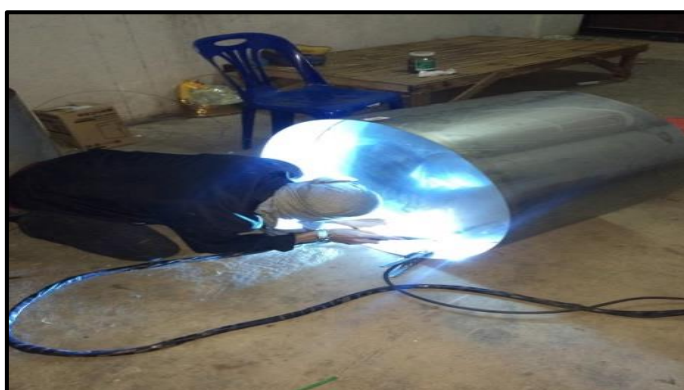
ภาพที่ 3-87 แสดงการเชื่อมประกอบใต้หม้อย้อมสี (ที่มา : วทีญญ บุตรศรี, 2561)
