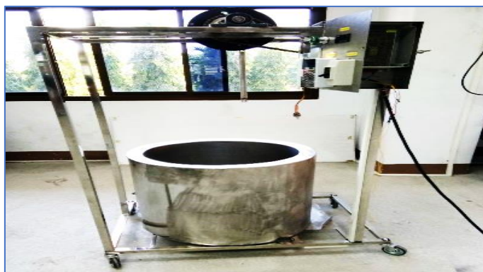
ภาพที่ 3-71 แสดงการทดสอบเครื่องย้อมสีเส้นไหมและฝ้ายในรุ่นที่ 3 (ที่มา : วทัญญู บุตรศรี, 2561)
