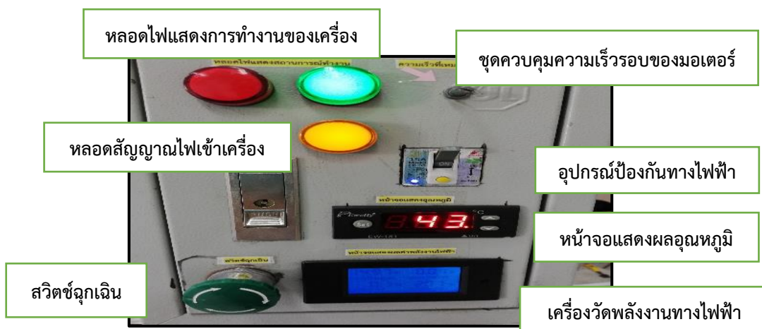
ภาพที่ 3-97 แสดงด้านหน้าของตู้ควบคุมระบบไฟฟ้าของเครื่องในรุ่นที่ 4 (ที่มา : วทิญญ บุตรศรี, 2561)
