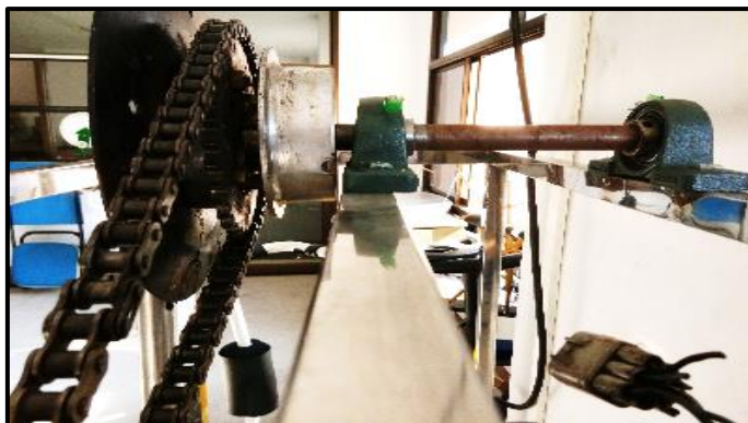
ภาพที่ 3-35 แสดงการประกอบและติดตั้งโซ่ช่วยส่งกำลังเข้ากับแกนเพลาคู่มือ (ที่มา : วทัญญู บุตรศรี, 2560)
