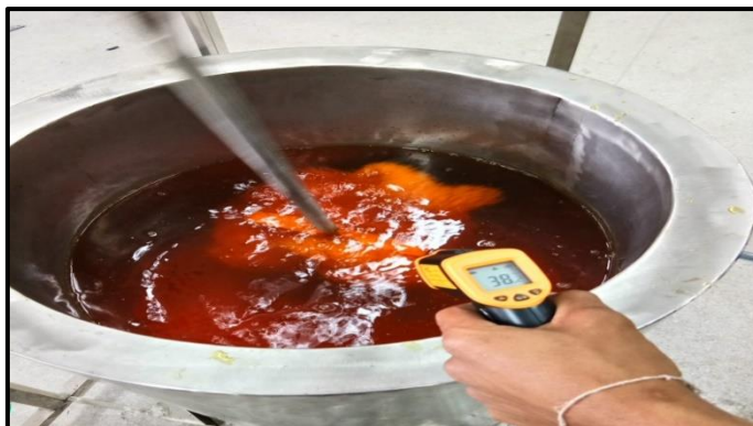
ภาพที่ 3-44 แสดงการทดสอบระบบในการทำงานของเครื่องโดยนำไปย้อมสีเส้นไหม (ที่มา : วัทัญญ บุตรศรี, 2560)
