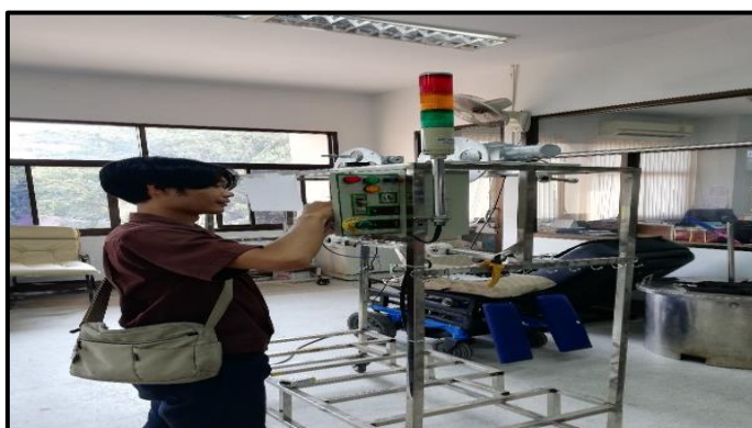
ภาพที่ 3-147 แสดงการประกอบตู้ควบคุมระบบไฟฟ้า (ที่มา : วทีญญ บุตรศรี, 2562)
