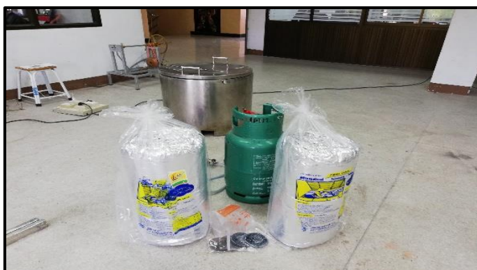
ภาพที่ 3-90 แสดงฉนวนกันความร้อนและหม้อแก๊ส (ที่มา : วทีญญ บุตรศรี, 2561)
