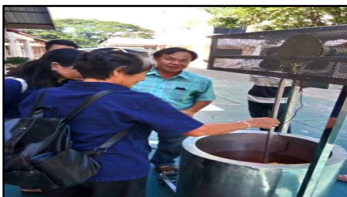
ภาพที่ 3-114 แสดงตัวแทนชุมชนบ้านคำขวางทดลองปรับระยะของชุดแกนยกเส้นไหม (ที่มา : วทัญญู บุตรศรี, 2561)
